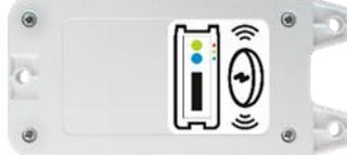
Рисунок 3 - Расположение беспроводного зарядного устройства на Радиомодемном блоке СЭТ-101М2
